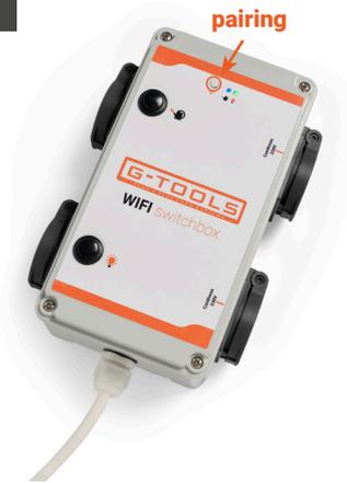
Houd de **pairing** knop op de Wifi Smart Box **7 seconden** ingedrukt totdat het **groene ledlampje 3 x snel knippert en 1 x lang**. Het apparaat zoekt nu naar uw Wifi netwerk. Afhankelijk van de sterkte van het Wifisignaal moeten er soms meerdere pogingen worden ondernomen voor de Smart Box verbinding maakt met de app.
